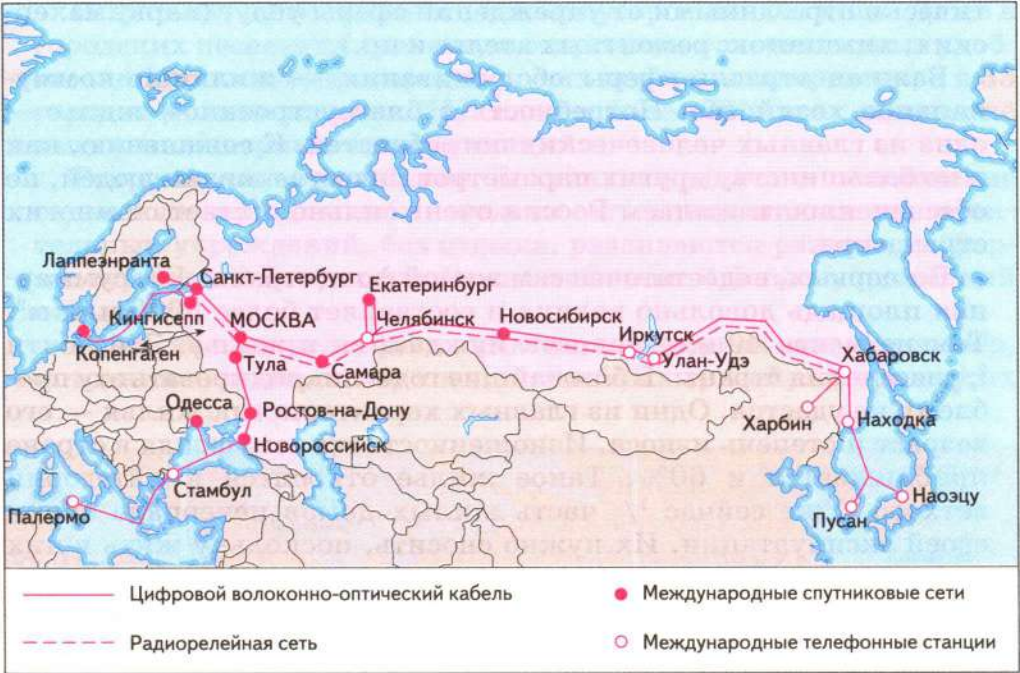
Рис. 68. Трансроссийская система волоконно-оптической связи
